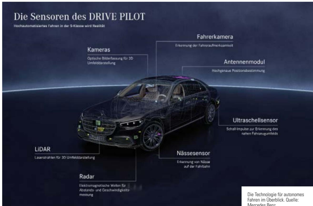
Die Technologie für autonomes Fahren im Überblick. Quelle: Mercedes Benz
