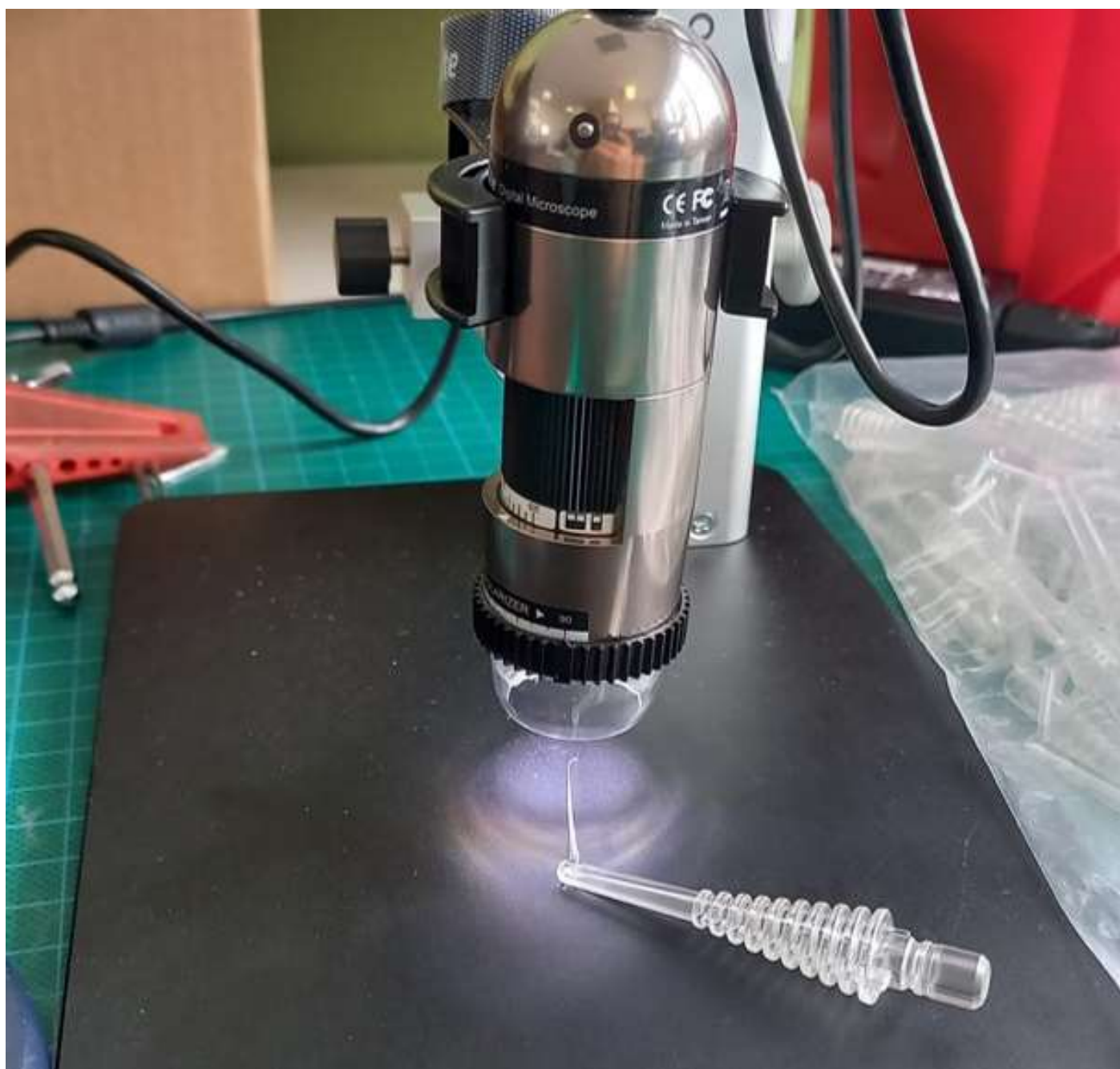
Abbildung 1: Untersuch der Dentalkanüle unter dem Mikroskop
