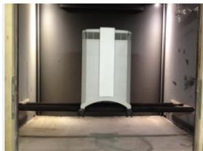
Abb. 4: Ansicht Prüfling auf Stahlrohre gestellt
