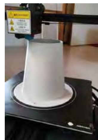
Abbildung 4: Druckprozess des konischen Zyklonteils
