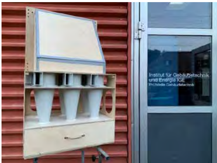
Abbildung 1: Betriebsbereiter Multizyklonfilter vor dem Institut für Gebäudetechnik und Energie IGE in Horw
