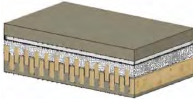
Abb. 4: Entwickeltes Brettstapel Holz mit Formschluss zur Verbindung des Lehmdeckenbekleidung, über den die Schüttungen aus Sand, Kies und Splitt, Trittschalldämmung und Lehmestrich gelegt werden.
