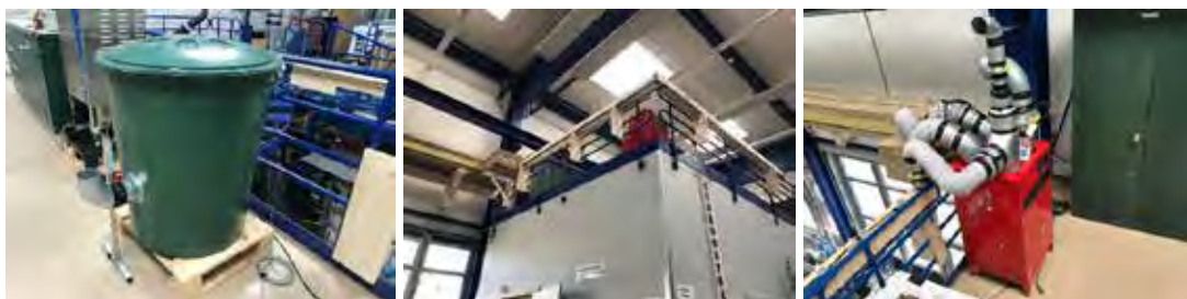
Abb. 1-3: Bestandteile des Versuchsaufbaus - von links nach rechts: Dampf-Luftbefeuchter und Dampfbehälter, Holzkanalleitungen, das angeschlossene KWL-Lüftungsgerät
