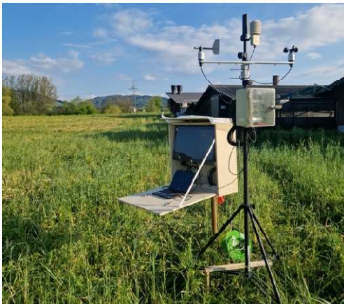
Abb. 3: Mess- und Wetterstation Feldmessungen im Einsatz
