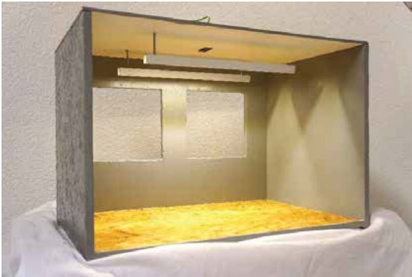
Abb. 2: Versuchsmodell mit dimmbaren Leuchten und Beleuchtungsstärke-Sensor
