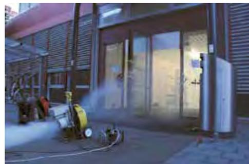
Abbildung 5 Rauchversuch während Tracergasmessungen
