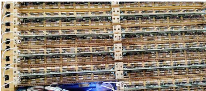
Abb. 2: Sicht in den Hochspannungs-Akkumulator mit dem Akkumulator-Management-System
