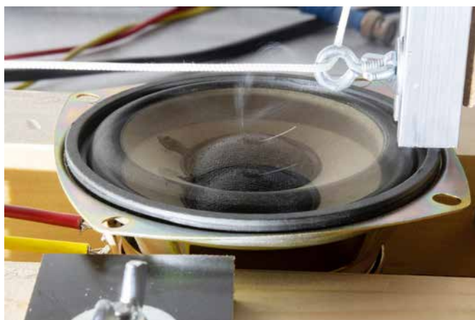
Abb. 3: Langzeitbelichtung (1s) eines angeregten Lautsprechers (100Hz) in einem abgedunkelten Raum. Mit Blitzfrequenz 200Hz und justierter Phase wird die Membran nur an den Extremalpositionen beleuchtet.
