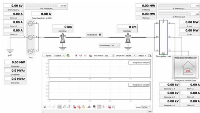
Abb. 2: SCADA Panel des Kurzschluss Modelles
