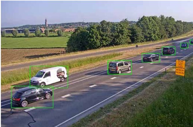
Abb. 1: Fahrzeugdetektion mit YOLO
