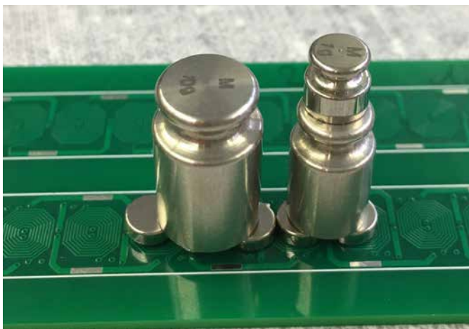
Abb. 2: Erueierung Nutzlast mit Gewichten
