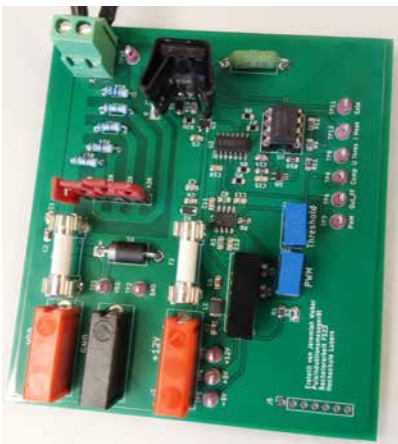
Abb. 2: Erstelltes PCB zur Ansteuerung der Sendespule
