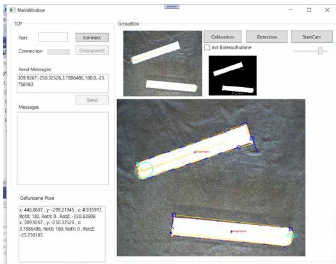
Abb. 2: GUI zur Steuerung der Bilderkennung und Positionsübertragung
