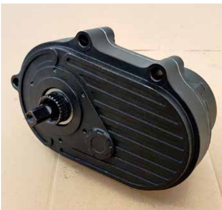
Abb. 3: Zeigt den TSDZ10 500W E-Bike Mittelmotor
