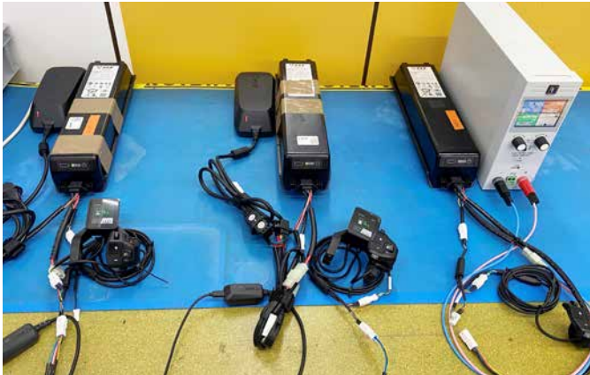
Abb. 1: Messplatz mit zwei Akkus am Aufzeichnen der Ladekurve (links) und ein Akku am Entladen (rechts)
