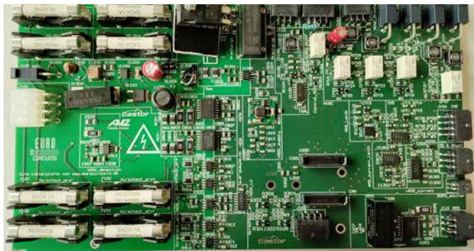
Abb. 3: Getestetes und für den Einbau vorbereitetes HVPCB
