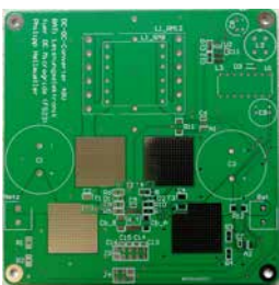
Abb. 3: Das unbestückte PCB. Mittig sind die grossen Kühlflächen der MOSFETs ohne Lötstopmmaske ersichtlich.
