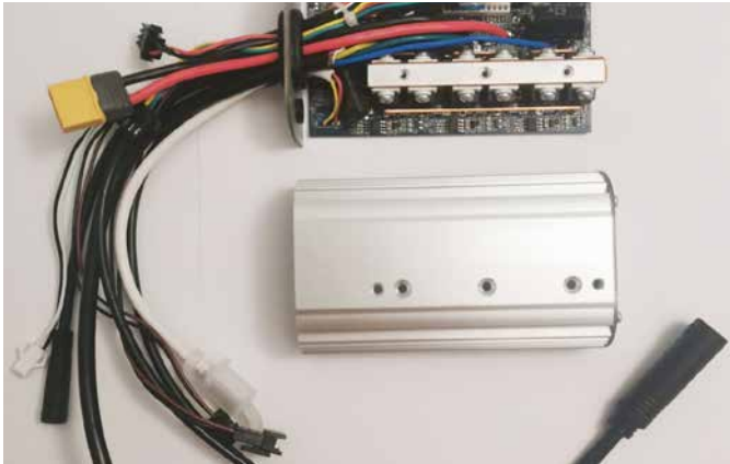
Abb. 1: Zeigt den kompletten E-Bike Controller mit allen Komponenten, Kabeln und Gehäuse vor dem Reverse Engineering.
