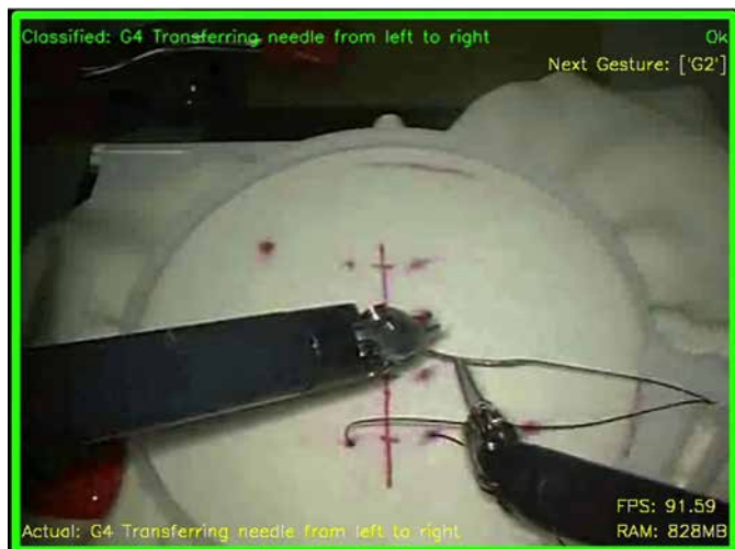
Abb. 3: Ausschnitt aus Gestenklassifizierung-Sequenz mit Actionevaluator
