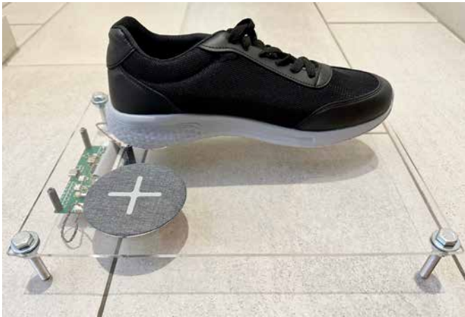
Abb. 1: Intelligente Ladestation während des Ladevorganges eines Schuhs
