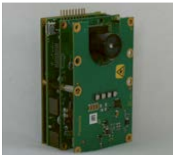
Abb. 1 3D-ToF-Kamera ohne Gehäuse
