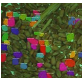
Abb. 4 Resultat der Bildverarbeitung – 42 Steine detektiert
