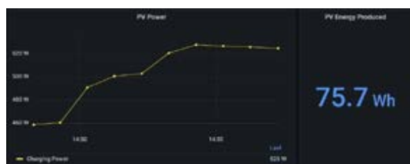
Abb. 4 Anzeige von Leistung und Energie der Solarpanels in Grafana
