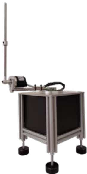
Abb. 1 Versuchsaufbau des Furuta Pendels
