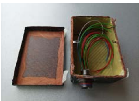
Abb. 4 Gehäuse der PCBs mit Motorsport-Lemo-Stecker
