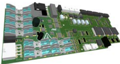
Abb. 3 High-Voltage-PCB zur Steuerung der Akkufunktionen
