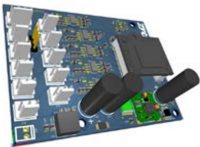
Abb. 2 FDE (Feder-Dämpfer-Elemente) – PCB
