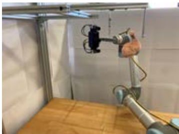
Abb. 2 Roboterbasierte Zelle für 3D Scanning
