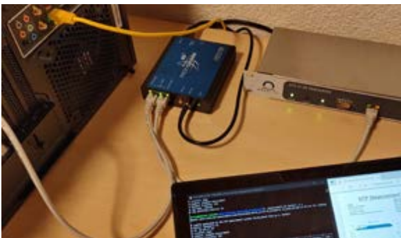
Abb. 2 Versuchsaufbau zum Ausmessen eines Zeitservers
