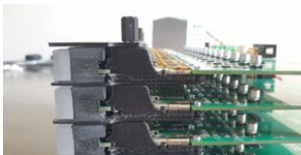
Abb. 3 Mechanischer Aufbau der Pixel-Einheit
