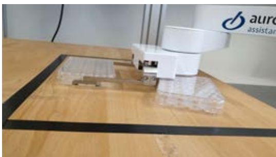
Abb. 3 Greifvorgang der Mikrotiterplatten mittels Roboter
