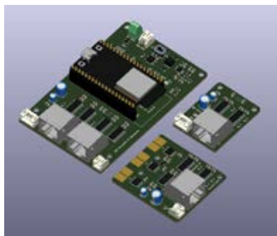
Abb. 3 3D-Ansicht der bestückten PCBs
