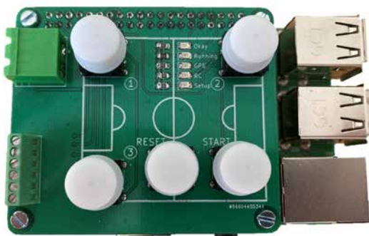
Abb. 3 Raspberry Pi mit HAT (Piloteninterface)
