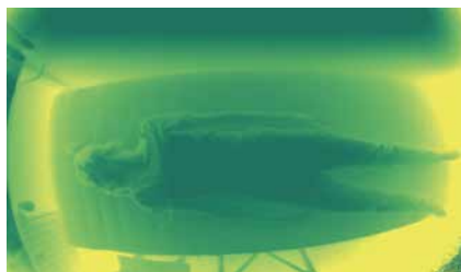
Abb. 2 Distanzbild einer Testaufnahme mit der Time of Flight Kamera
