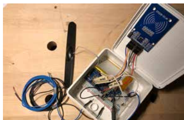
Abb. 3 LoRa-Modul: Arduino MKR WAN 1310 mit Batterie, Antenne und RFID-Reader.
