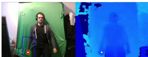
Abb. 1 Links: Farbbild, Rechts: Tiefenbild. Die Hand des Patienten wird im Farbbild erkannt und die Distanz einer Hand zur Kamera gemessen.
