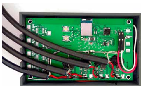
Abb. 4 Funktionsmuster mit integriertem Batteriehalter und Elektronik
