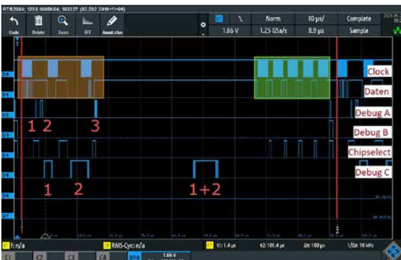
Abb. 3 Datentransfers innerhalb eines Zyklus. Das Auslösen verschiedener Aktionen ist mit den Debugsignalen A bis C dargestellt.
