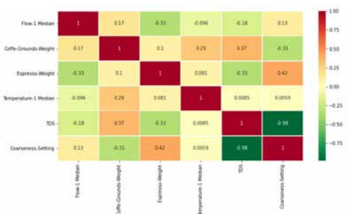
Abb. 3 Es konnte gezeigt werden, dass der Extraktionsgehalt in einer linearen Abhängigkeit mit der eingestellten Mahlgradeinstellung steht.
