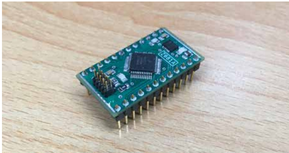
Abb. 1 Entwicklungsboard für IO-Link Device-Stack: IO-Link HAT mit NXP MK02FN128 Mikrocontroller und HMT7742 PHY (IO-Link Transceiver)
