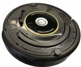
Abb. 1 Eine bestehende Roboterplattform wurde zur Schmutzdetektion modifiziert.
