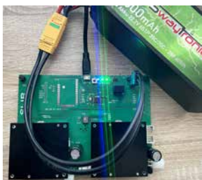
Abb. 4 Entwickeltes Control PCB mit Inclinometer und Motoren Controller
