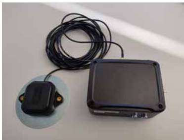
Abb. 1 Realisiertes Funktionsmuster mit externer GNSS Antenne
