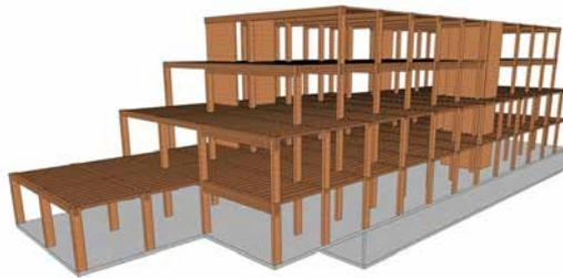
Abb. 2: Tragwerk SKZ (ohne Betonschicht)
