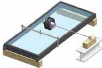
Abb. 2: Verwendete Versuchskörper    Abb. 3: Versuchsaufbau mit dem Doppelreifen als Stosskörper
