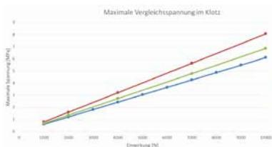
Bild 8: Maximale Vergleichsspannung im Klotz im Basismodell
