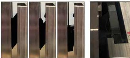
Abbildung 3: Scherversuch A/R = 0.5 & 1.875
