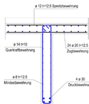
Abb. 8: Bewehrung der Hauptträger über Stütze
