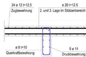
Abb. 6: Bewehrung der Feldträger über Stütze
