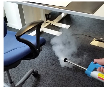
Zugluftvisualisierung durch Rauchaufgabe bei einem Arbeitsplatz
