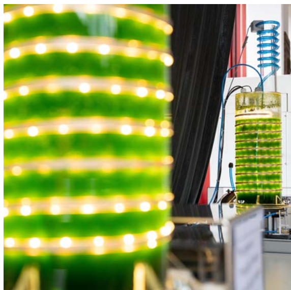
Abb. 12: Photobioreaktoren zur Kultivierung von Mikroalgen zur biologischen CO 2 -Bindung (Quelle: HSLU Hochschule Luzern)
