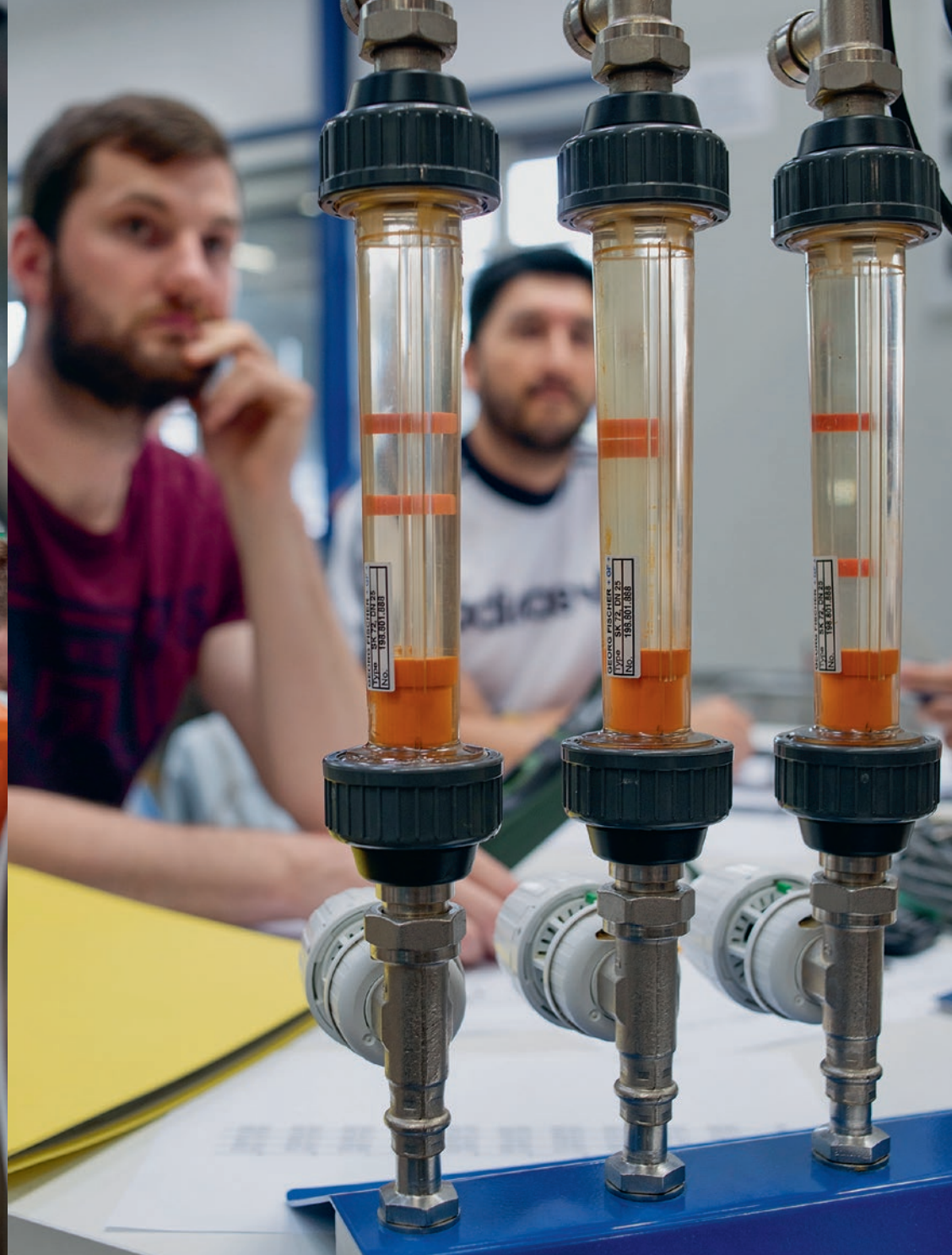
Studierende der Studienrichtung Heizung-Lüftung-Klima-Sanitär (HLKS) im Labor bei einem Versuch zum hydraulischen Abgleich.
