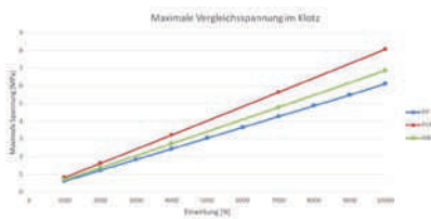
Bild 8: Maximale Vergleichsspannung im Klotz im Basismodell
