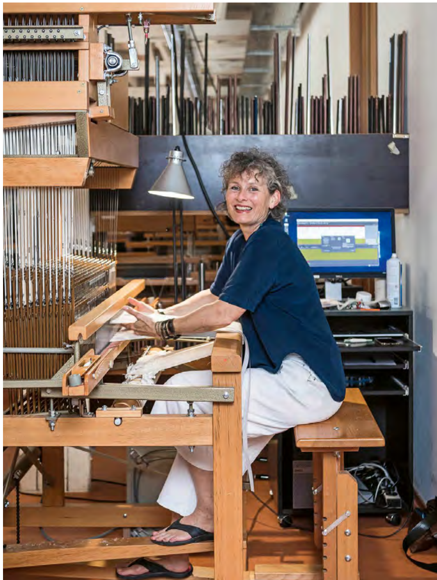
Tina Moor produziert an ihrem Handwebstuhl verschiedene Stoffstücke, um die Materialeigenschaften der Bananenfaser zu testen.
