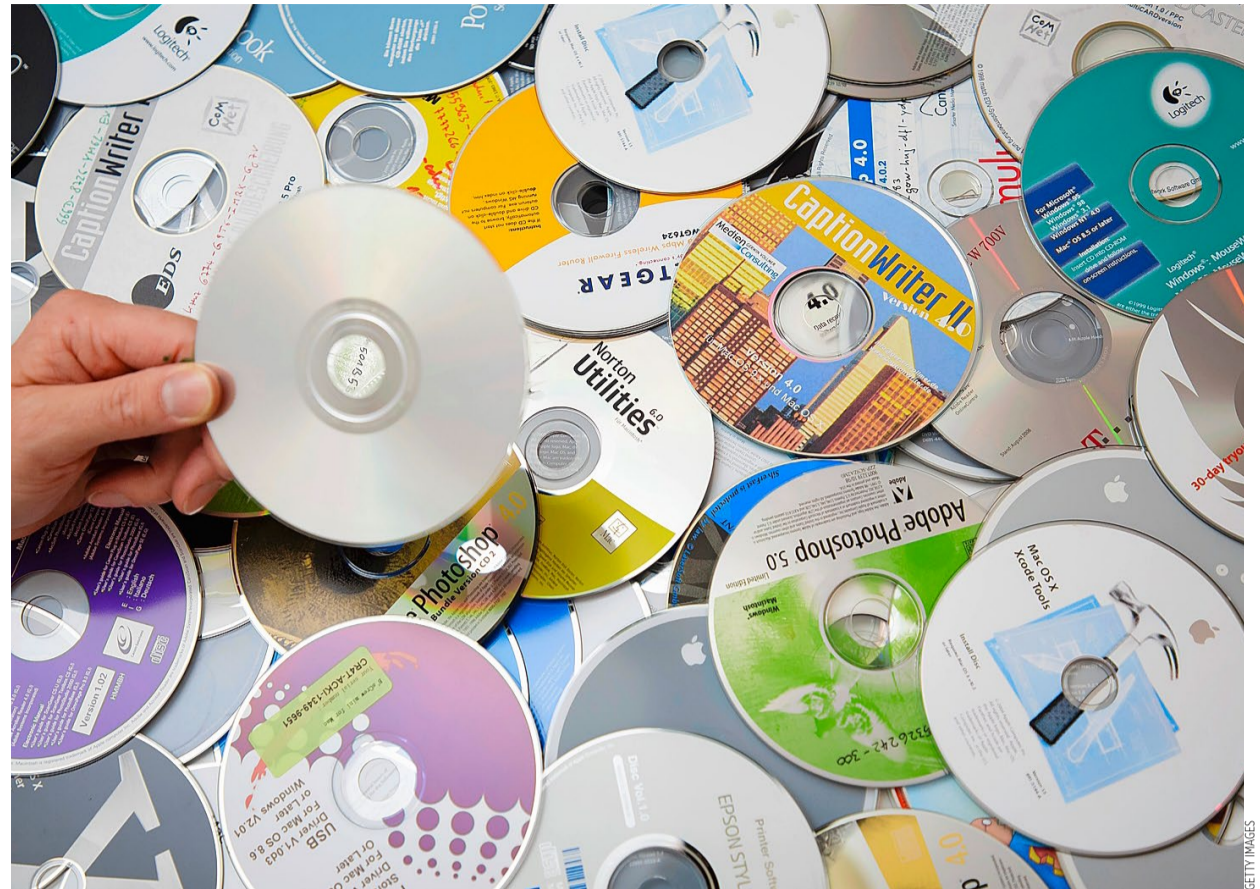
CD: Als optische Datenträger debütierte die CD 1989. Sie kann Datenmengen von 650 bis 900 Megabyte speichern.
