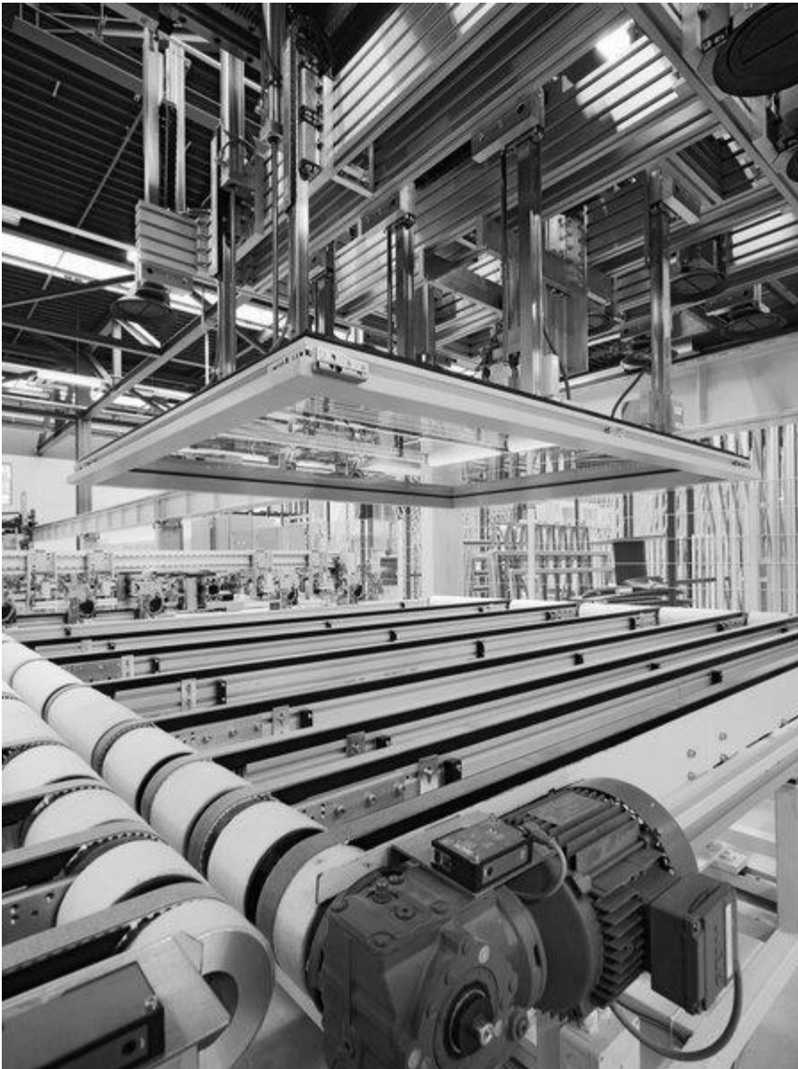
Automatisierte Fertigung: Flügel-Verglasungszelle «Saphir Integral» (Quelle: Unternehmensbroschüre G. Baumgartner AG)
