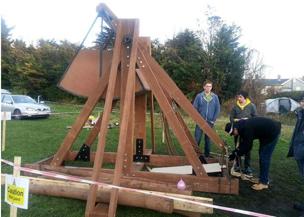
Die Trebuchet ist eine Belagerungsmaschine, wie sie im Mittelalter verwendet wurde
