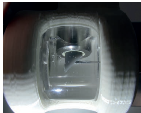
Nahaufnahmen der Phakospitze während einer Okklusion in der künstlichen Augenkammer.
