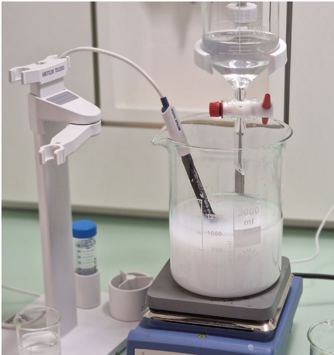
Abbildung 1: Aufbau der Titrationsvorrichtung für die nasschemische Fällung.
