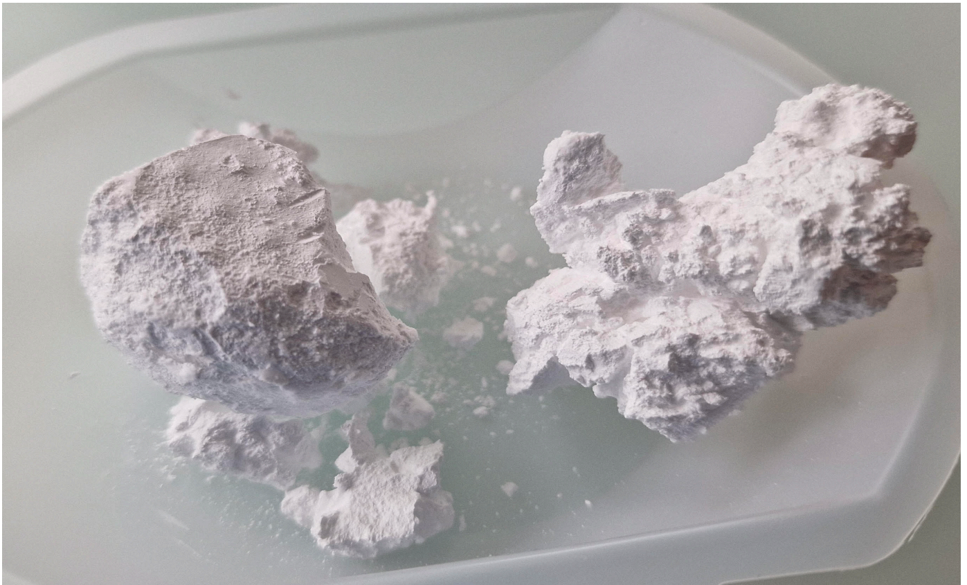
Abbildung 4: Getrocknetes HAp-Pulvers mit sichtbarer Agglomeratbildung.
