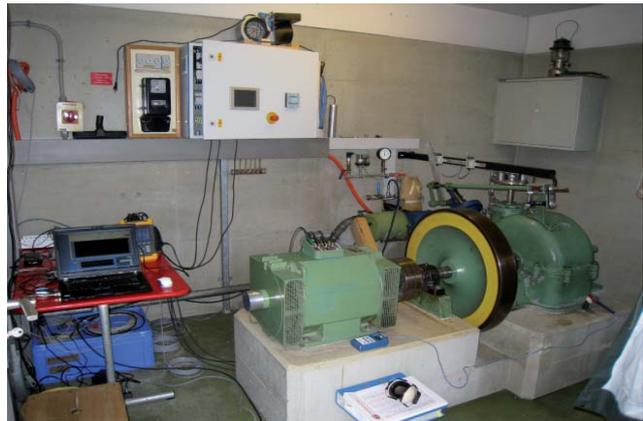
Messeinrichtung zur Bestimmung des hydraulischen Wirkungsgrads beim Kleinwasserkraftwerk Wilen.
