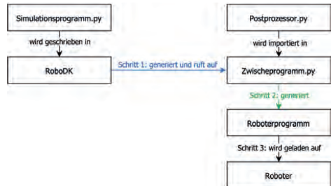
Abb. 2: Flussdiagramm einer Generierung eines Roboterprogrammes in RoboDK
