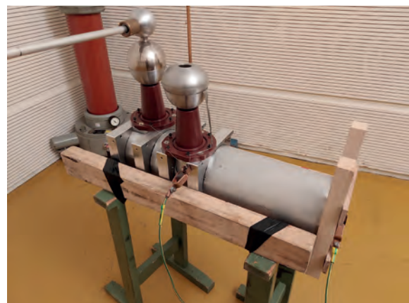
Abb. 3: Elektrische Prüfung am verbesserten Prototyp im Hochspannungslabor
