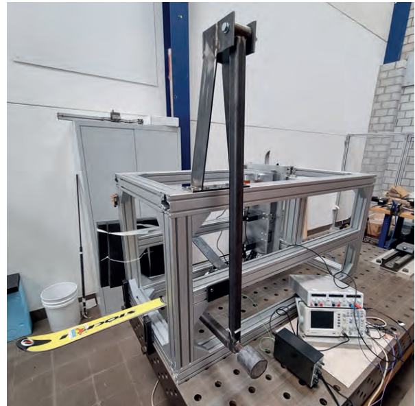
Abb. 2: Laborprüfstand mit Pendelhammer zur Erzeugung von Stössen
