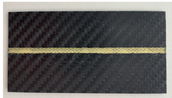
Abb. 3: Kohlenfaser-Kevlar-Scharnier von Pinet Industrie
