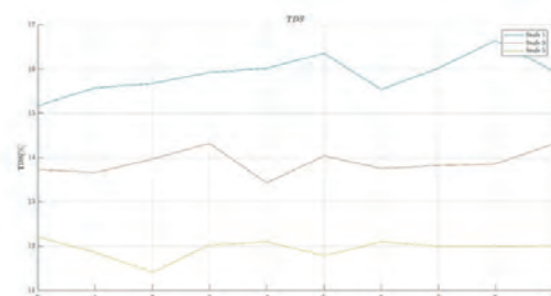
Abb. 3: Veränderung des Extraktionsgehalts bei Variation des Mahlgrads
