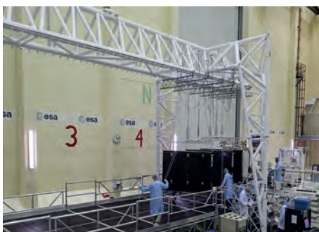
Abb. 1: Passives System von der ESA (Foto: BepiColombo MTM Solar Array deployment ESA ESTEC 16 April 2017 Carreau 2017)
