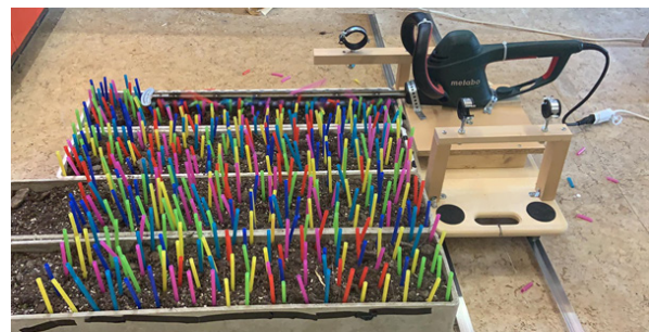
Abb. 2: Versuchsaufbau zur Ermittlung der Leistungsaufnahme bei der «Vegetation» Plastikstrohhalm
