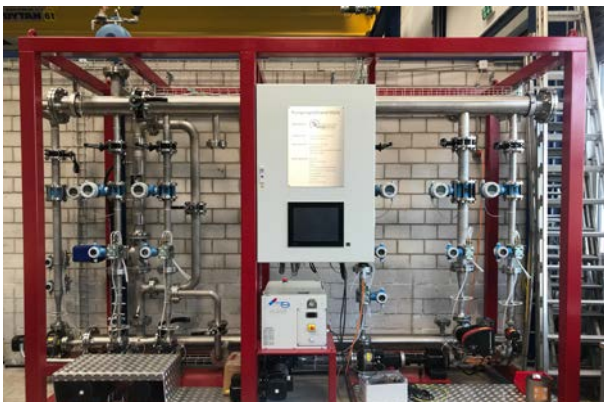
Abb. 1: Pumpenprüfstand im Hydrolabor des Kompetenzzentrum Fluidodynamik und Hydromaschinen
