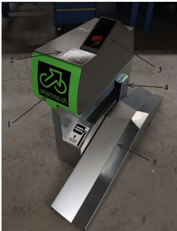
Abb. 1: Bestehende Ausgangssituation: Veloparkplatz mit ausziehbarer Schublade (1), Helmbox (2), Bildschirm für Sicherungs- und Entsicherungsvorgang (3), Verriegelungsmechanismus des Pedals (4), Radführung (5)
