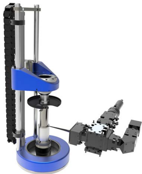
Abb. 2: Universalwerkstückträger mit eingespannter Antriebskombination und Laseroptik
