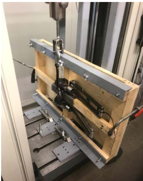
Abb. 1: Mobiler Dachbefestigungspunkt im Zugversuch
