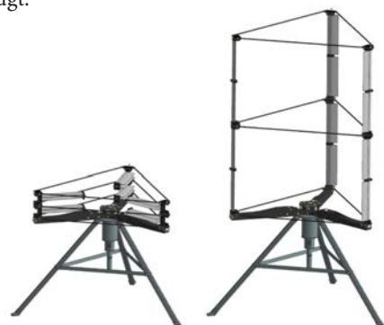
Abb. 3: Konzept Mars-Windgenerator, links: Transportzustand, rechts: einsatzbereiter Zustand
