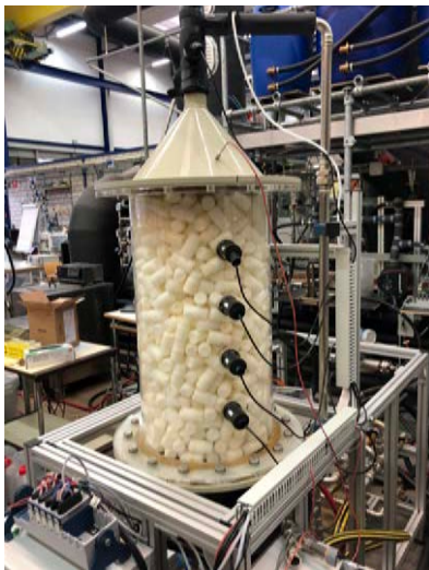
Abb. 1: Experimenteller Setup: Latentwärmespeicher mit makroverkapseltem Phasenwechselmaterial im Labor für Thermische Energiesysteme
