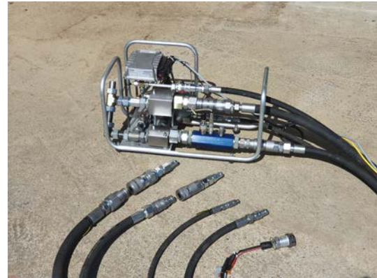
Abb. 1: Realisierter Traktortester in Rohrleitungsbauweise
