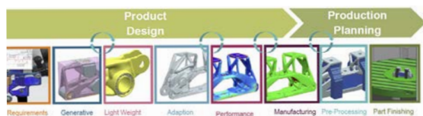
Abb. 1: NX-Prozesskette eines additiv gefertigten Bauteils (Quelle: Siemens PLM)
