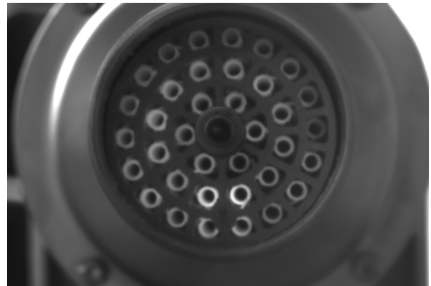
Abb. 2: Machbarkeitsnachweis zum Erkennen der Temperatur-Hotspots
