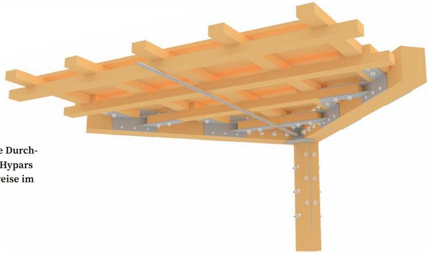
Konstruktive Durchbildung des Hypars in Holzbauweise im Eckbereich
