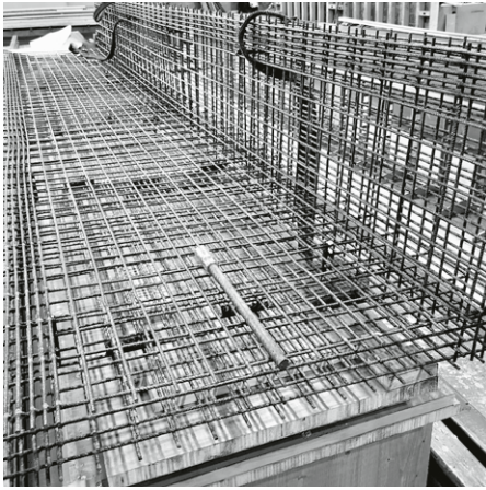
Ausführung der Bewehrung eines Versuchskörpers
