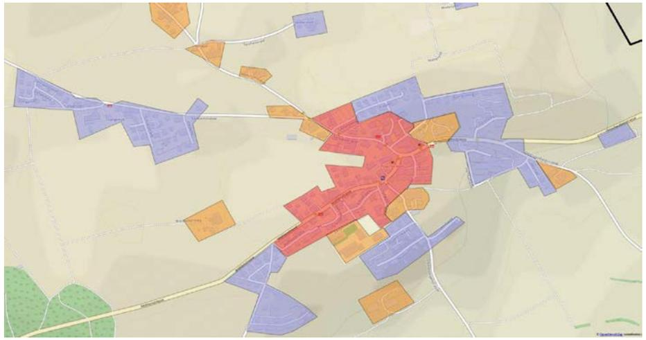
Das empfohlene Energiekonzept für das Dorf Uettligen in Wohlen bei Bern im Überblick. Rot: Wärmeverbund für Warmwasser und Raumwärme. Blau: Energetische Sanierung und ein Ersatz der Wärmeerzeuger mit vornehmlich Wärmepumpensystemen. Orange: Kombination von energetischer Sanierung und dem Einsatz von Holzheizungen für die verstreuten Gebäude. Weiterer Bestandteil in allen Gebieten ist der umfangreiche Zubau von Photovoltaikanlagen. (Bild: Hochschule Luzern)
