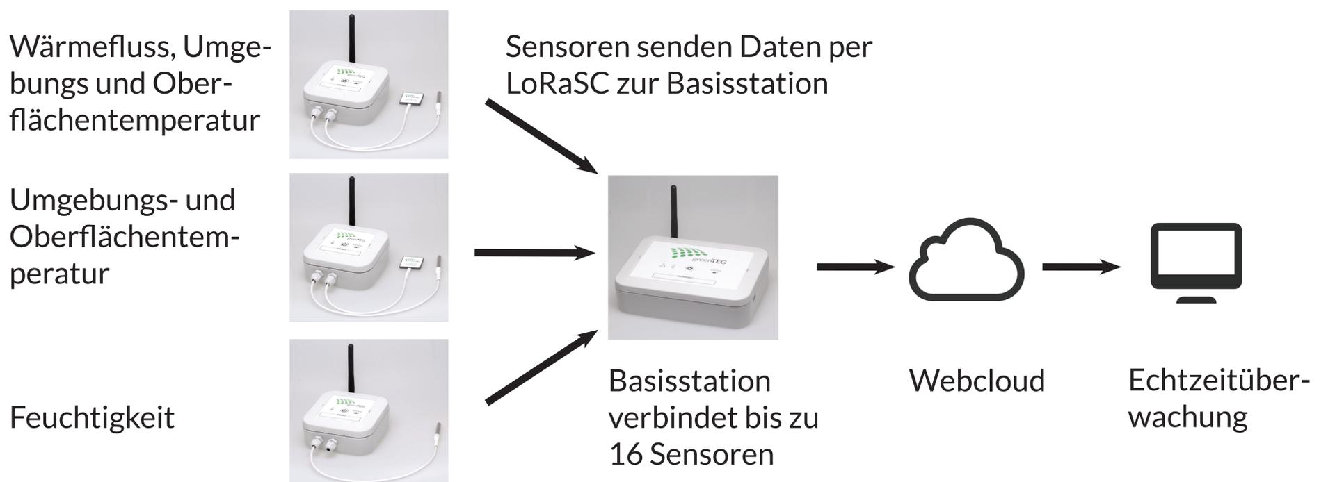
$$\text{Formel U-Wert: } U = \frac{\text{Wärmefluss in Watt}}{\text{Temperaturdifferenz (Innen/Aussen)}}$$
