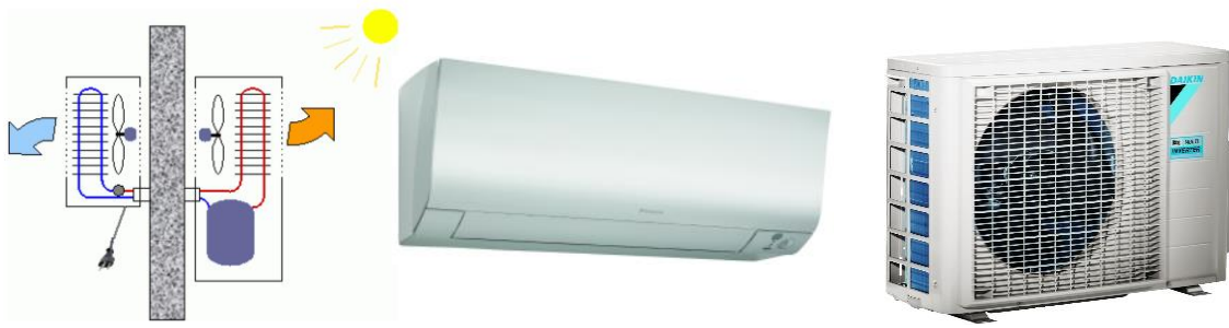
Abbildung 5: Links: Schematische Darstellung der Funktionsweise eines Split-Systems. Quelle: Brunner, Steinemann, & Nipkow, 2008. Rechts: Abbildungen eines Innenraum- und Aussenraumgerätes. Quelle: Daikin Industries, Ltd..
