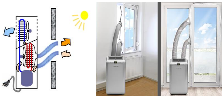
Abbildung 4: Links: Schematische Darstellung der Funktionsweise eines Zweikanalsystems. Quelle: Brunner, Steinemann, & Nipkow, 2008. Rechts: Abbildungen eines mit einem Fensteradapter bzw. Türadapter installierten Systems. Quelle: Trotec GmbH.
