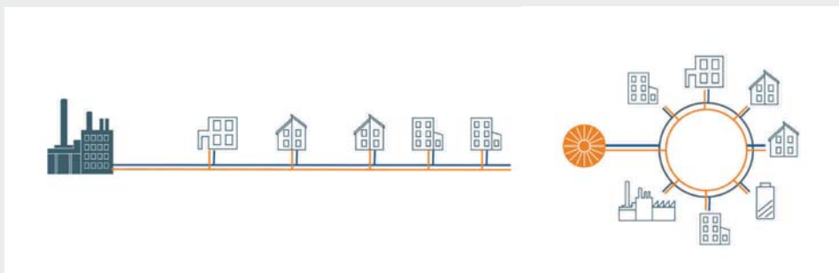
Fig. 2 Entwicklung der thermischen Energieversorgung: zentral und unidirektional (links) und bidirektional (rechts) Développement de l'approvisionnement en énergie thermique: central et unidirectionnel (à gauche) à décentralisé et bidirectionnel (à droite)
