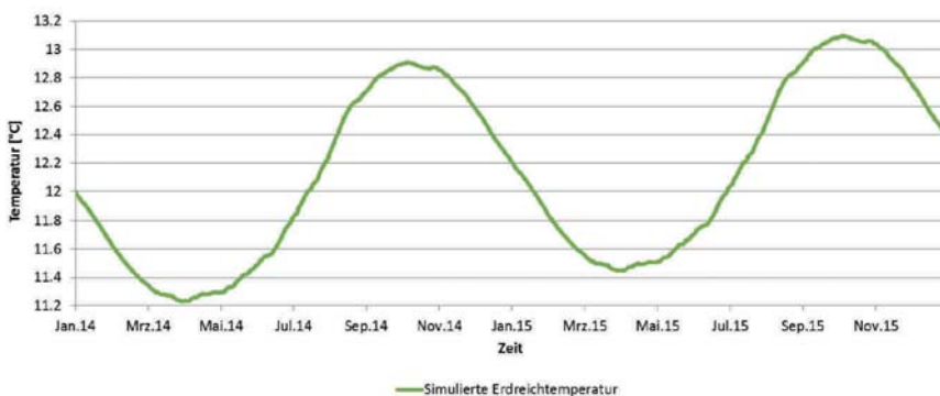
Fig. 6 Verlauf der Erdwärmespeichertemperatur nach erfolgtem Endausbau Aperçu de la température de stockage de l'énergie géothermique après l'achèvement de l'étape finale
