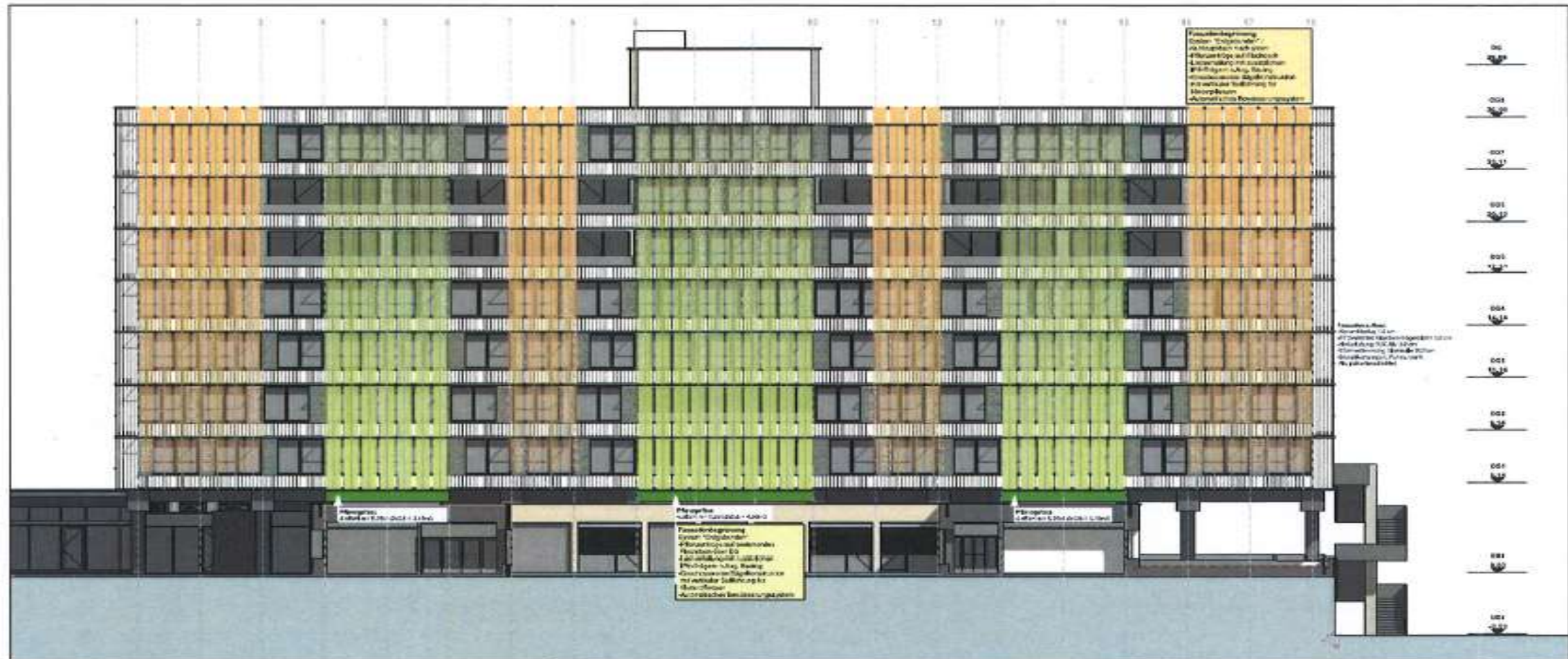
Schema Fassadenbegreenung Südostfassade 1:100
