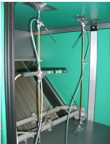
Abbildung 13: Platzierung der Temperaturfühler, sowie des kombinierten Temperatur- und Feuchtefühlers im Abluftkanal
