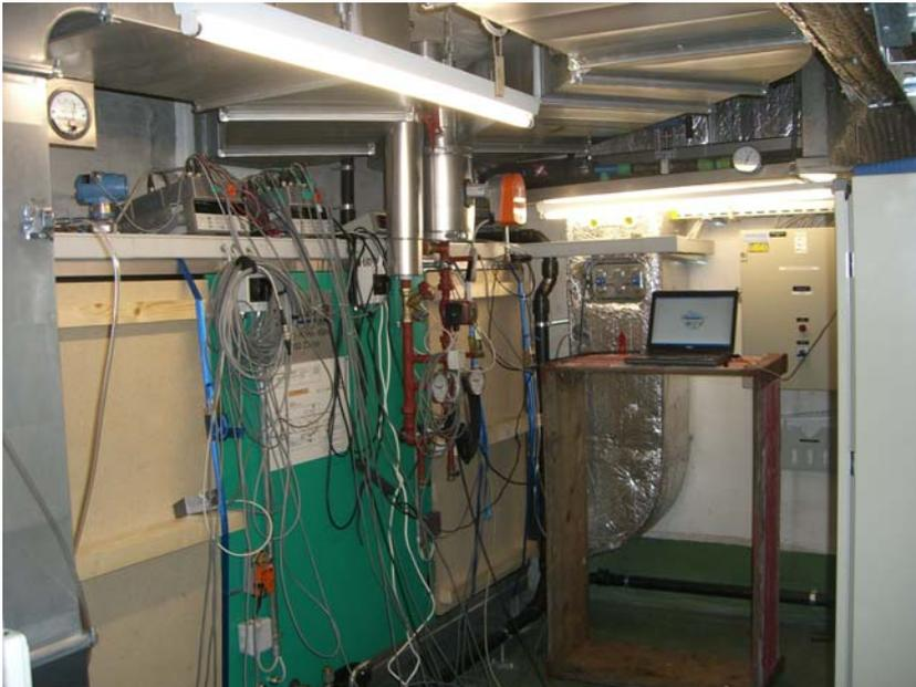
Abbildung 12: Lüftungsgerät mit Messtechnik
