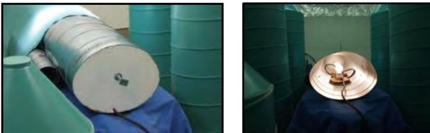
Abbildung 23: Versuchsaufbau zur Schutzgradbestimmung bei Betrieb eines Warmflächenheizsystems zur Patientenwarmhaltung, simuliert durch eine hohe Beheizung vom Patientendummy (200 W).
