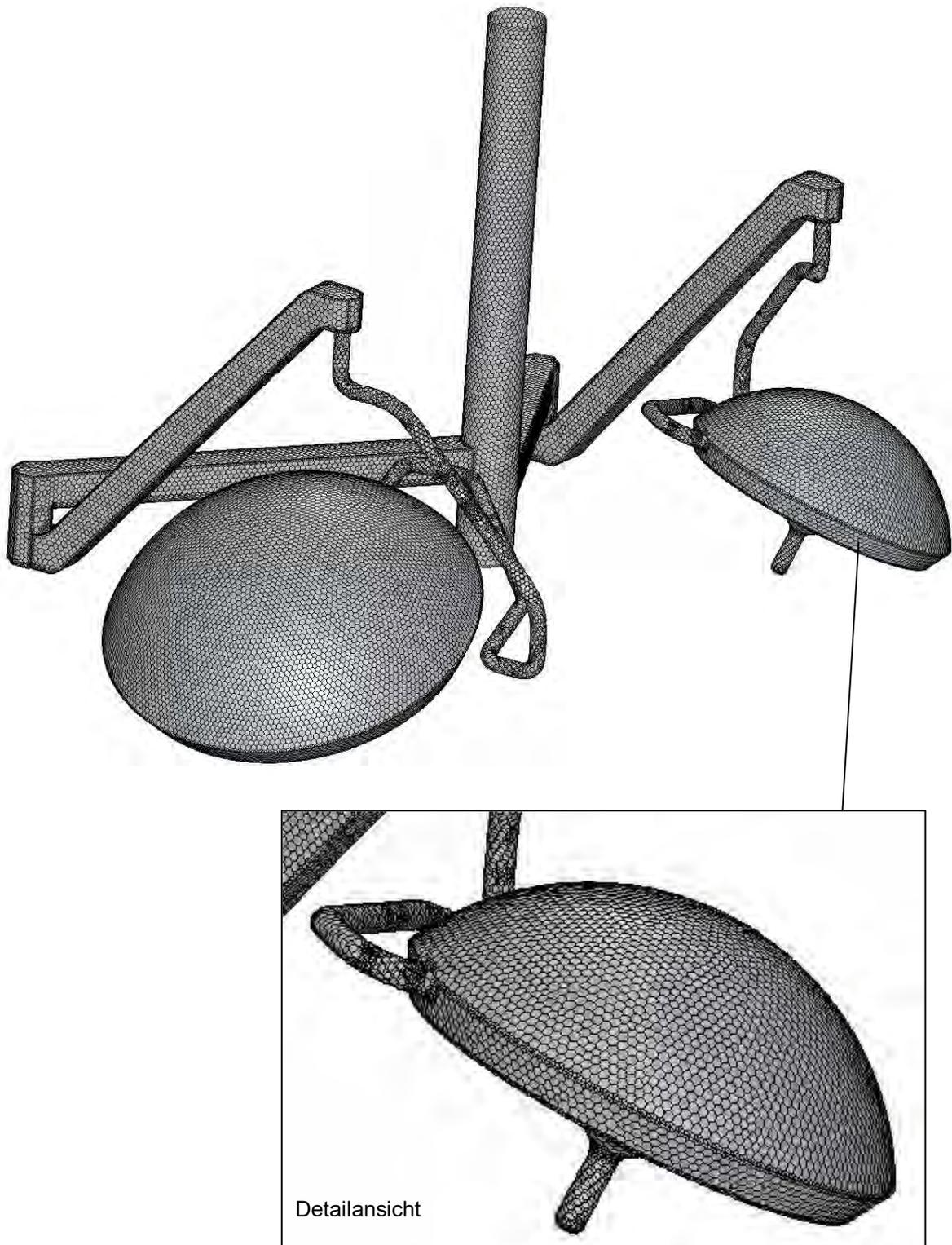
Bild 7.2.3: Oberflächennetz auf den Lampen über dem OP - Tisch nach der Konvertierung in Polyeder
