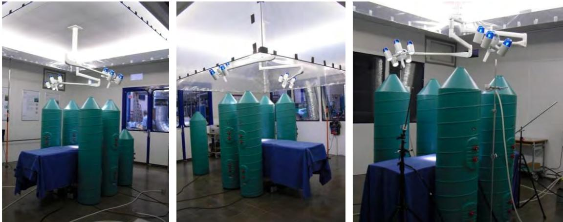
Abbildung 5: Versuche mit TAV-Lüftung, Variation der Schürzenlänge, Partikel-Ausströmer gemäss DIN 1946-4/ SWKI 99-3 auf dem Fussboden, b d „I d “, b w. b k S chü zen auch in 1.7 m Höhe.
