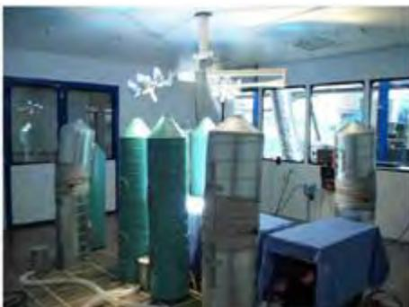
Abbildung 32: OP-Raum mit Mischlüftung und hoher Musterlastbelegung
