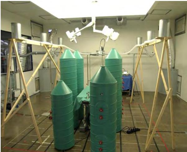
Abbildung 27: Versuchsaufbau beim OP-Lüftungskonzept „Schichtlüftung“ mit hochgestellten Partikel ausströmern.
