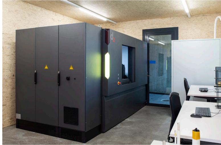
zeiten ermöglichen auch, einen Prozess im Ablauf zu untersuchen, um damit die inneren Veränderungen des Objektes in 3D verfolgen zu können. LuCi kann eine breite Palette von Materialien untersuchen: von Holz über Aluminium bis zu Stahl oder noch dichteren Elementen. Nebst technischen Prüfkörpern können aber auch biologische Proben wie Gemüse, Früchte, Käse und auch Gewebeproben untersucht werden.
