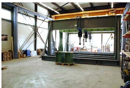
Prüfhalle 2 mit drei Portalrahmen 1000 kN
