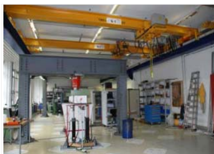
Prüfhalle 1 mit Aufspannfeld und Kranbahn
