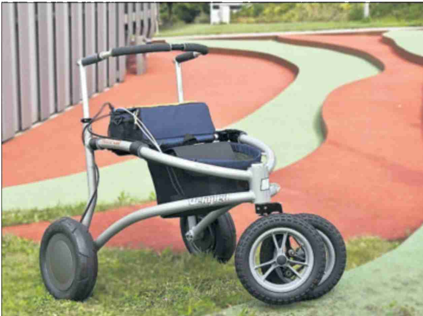
Geländegängig und mit Elektroantrieb: der erste Rollator-Prototyp der Hochschule Luzern.
