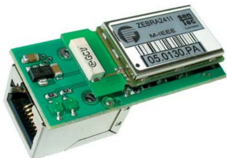
Abb.3: EtherBee ist ein preisgünstiger Gateway für Ethernet-Kommunikation auf ZigBee-Funk.
