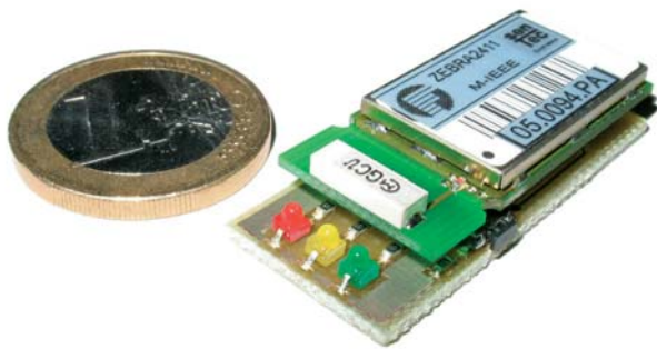
Abb. 1: «Webee» ist eine ZigBee-funkfähige Steuerelektronik für Sensoren und Aktoren.
