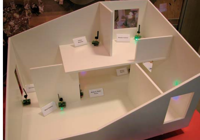
Abb. 2: Anschauungsmodell eines funkvernetzten Gebäudes.
