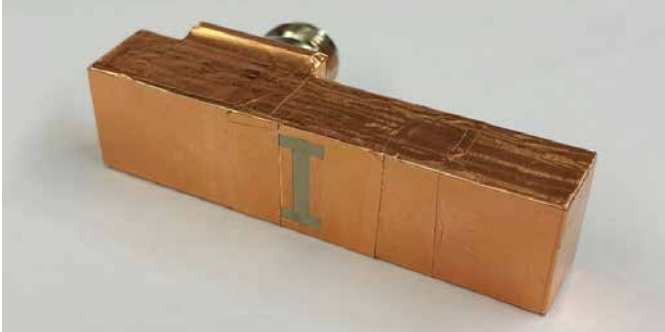
Abb. 1: Prototyp der geschlitzten Hohlleiterantenne
