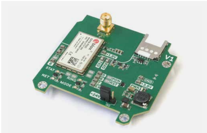
Abb. 1: Der Kommunikationsmodul-Prototyp mit dem SARA-R520-02B Modul
