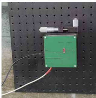
Abb. 2: Montiertes PCB mit Sensor und ausgerichtetem Laserstrahl
