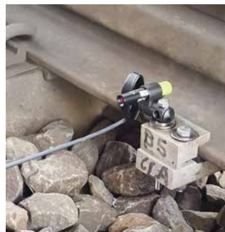
Abb. 3: Laserhalterung an der Schiene in Brunnen
