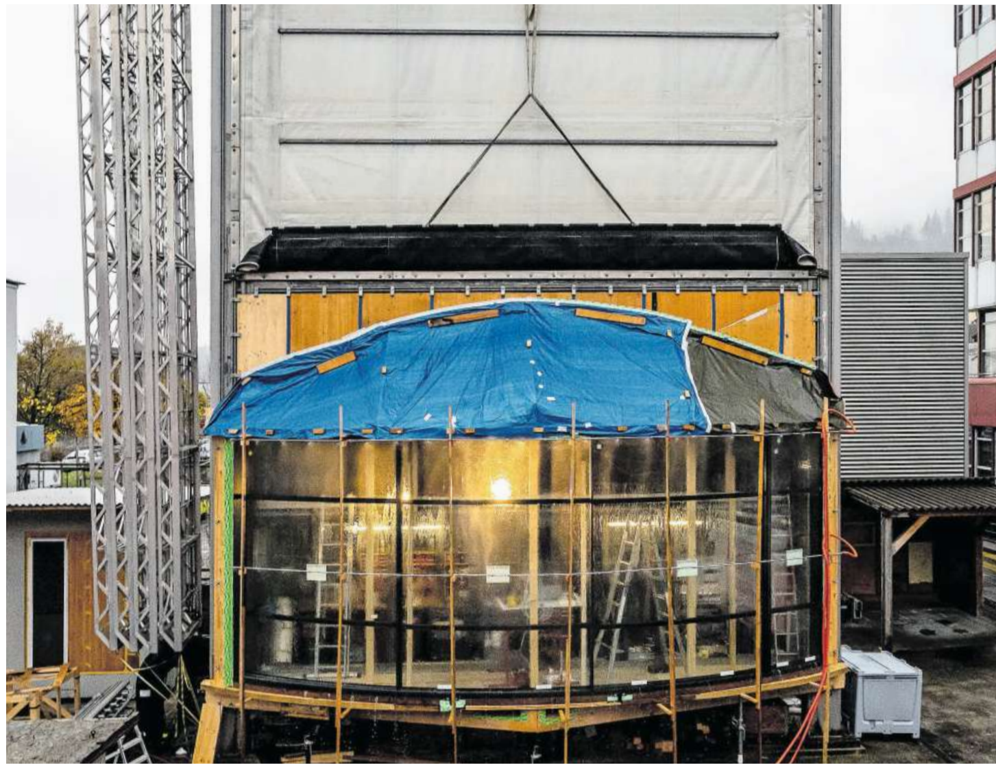
Dieses Fassadenstück aus gebogenem Glas wird nach erfolgreichen Tests in einem ehemaligen Londoner Einkaufszentrum eingesetzt, das für 1,25 Milliarden Franken saniert wird. Bild: Nadia Schärli (Horw, 17. November 2021)
