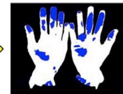
Schritt 4: Farbschwellwertvergleich im Y-Cb-Cr-Farbmodell
