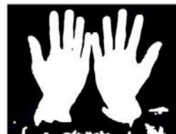
Schritt 2: Löcher entfernen (Erosion & Dilatation)
