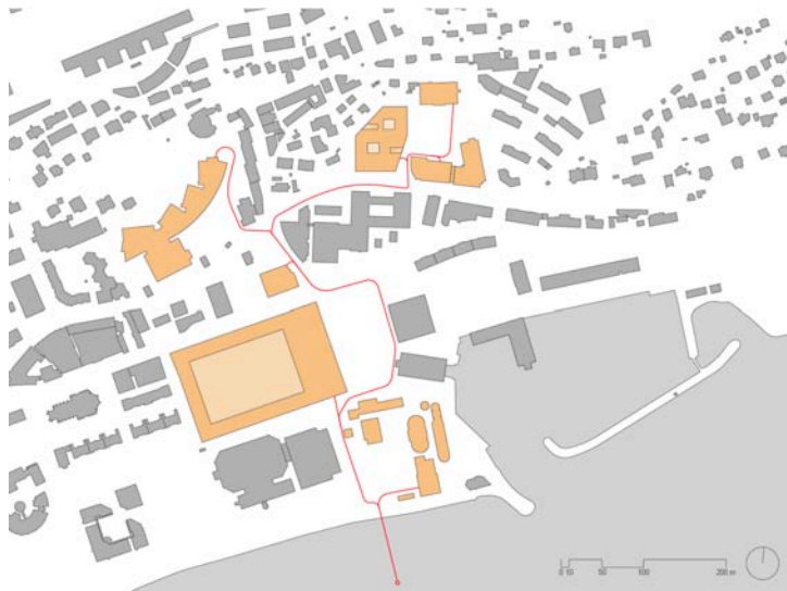
Erneuerbare Energien | Unterirdische Leitung für Seewasser zur ökologischen Gebäudekühlung | 2,2 mio kWh/Jahr (ca. 630 Haushalte)
