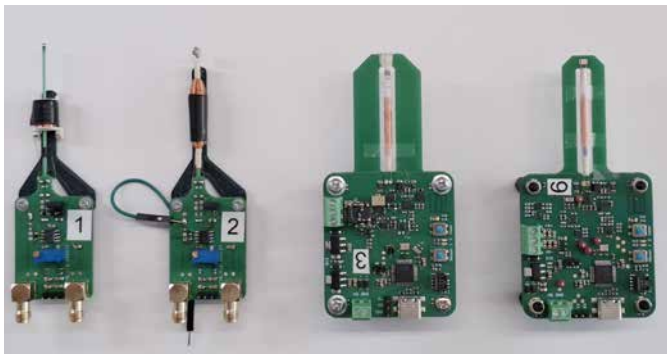
Abb. 3: Im Rahmen der Bachelor-Thesis entwickelte Leiterplatten. Die erste Iteration ist links und die neueste ganz rechts zu sehen. Die Nummern 1 und 2 dienen der Reproduzierung des Sensorkonzepts. Nummer 3 und 4 enthalten jeweils ein vollständiges Messsystem.
