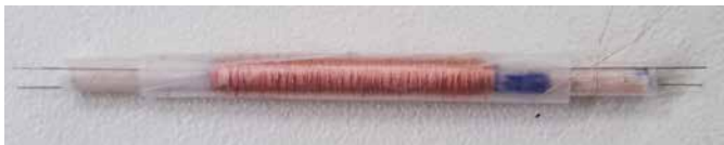
Abb. 2: Hergestellter 50 mm langer Sensorkopf. Die amorphen Drähte für die Anregung stehen links und rechts heraus. Die Ausgangsspannung wird in die ersichtliche Pick-Up-Wicklung induziert.
