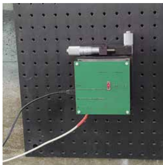
Abb. 2: Montiertes PCB mit Sensor und ausgerichtetem Laserstrahl
