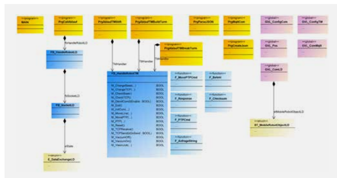
Abb. 3: Klassendiagramm des TwinCat-Programms
