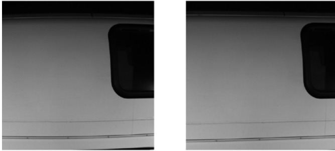
Abb. 1: Bild vor und nach der Kalibration mit den Kameraparametern. Links sind die eigentlich geraden Linien noch gekrümmt. Rechts sind sie gerade. Es besteht allerdings immer noch ein perspektivischer Effekt.
