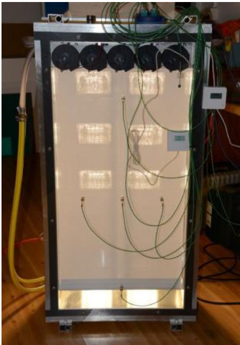
Abbildung 4: Versuchsfenster II. Links die raumseitige Einscheibenverglasung und rechts die mit Halogenscheinwerfern bestrahlte 3-fach Verglasung.
