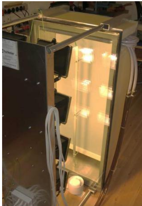
Abbildung 4: Versuchsfenster II. Links die raumseitige Einscheibenverglasung und rechts die mit Halogenscheinwerfern bestrahlte 3-fach Verglasung.
