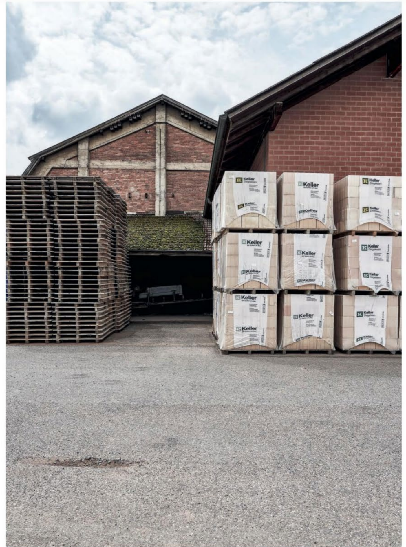
Weil der Ofen am besten niemals ruht, ist vor allem der normale Backstein Lagerware. In Frick lagern meist knapp zwei Millionen Steine, der Ausstoss eines Quartals.
