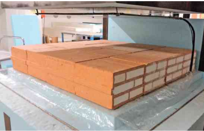
Am Empa-Labor für Materialien und Komponenten für energieeffiziente Gebäude haben Forscher einen Dämmziegel entwickelt, der mit dem stark wärmedämmenden Material Aerogel gefüllt ist. Der Dämmziegel erreicht mit 59 \text{ mW}/(\text{m}\cdot\text{K}) die tiefste jemals mit Backsteinen erreichte Wärmeleitfähigkeit. (Bild: Empa)
