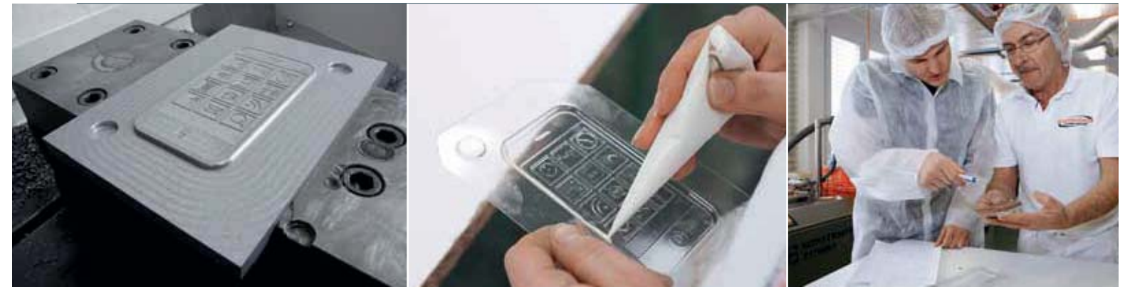
Die Musterform für das Smart Phone aus der hochporösen Aluminiumart Metapor.
