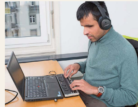
Nagesh Beltrami arbeitet mit Braille-Zeile, der PC-Tastatur und einer Sprachausgabe.
