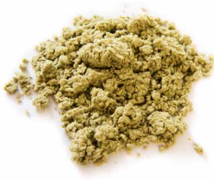
Die Dämmelemente TexLining sind mit granulöser Steinwolle gefüllt.
