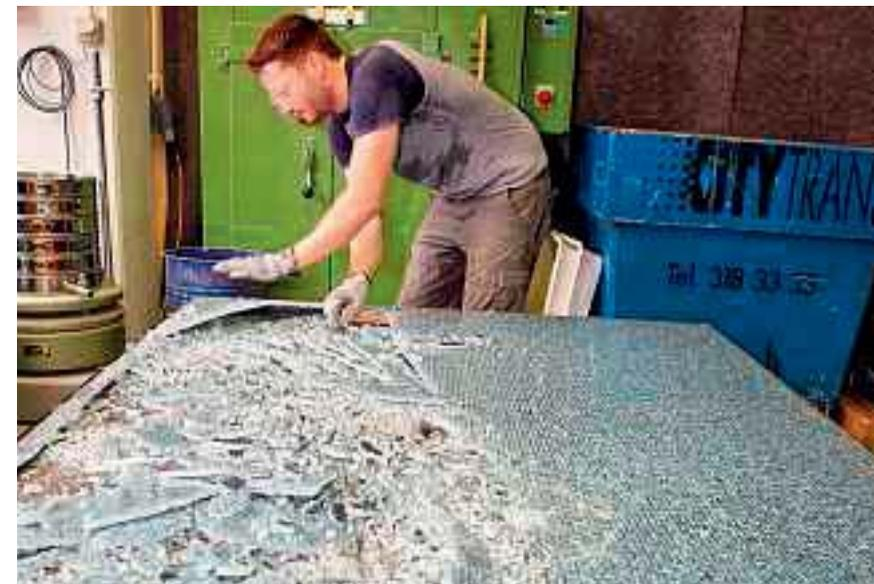
Den Aufprall der Stahlkugel übersteht das Glas nicht: Die oberste Schicht splittert.
