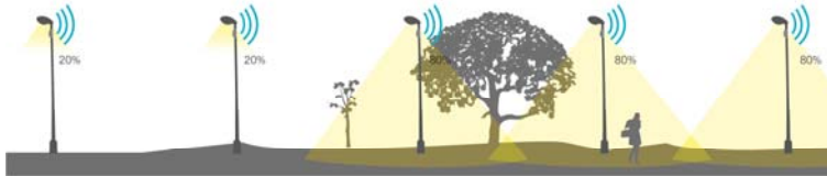
Abbildung 2: Bedarfsgerechte Steuerung der Beleuchtung im Falle von Personen
